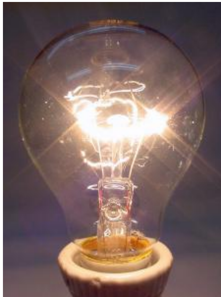
Lámpara de filamento de tungsteno en espiral , en atmósfera gaseosa
